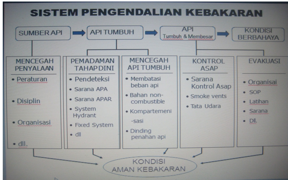
Gambar 8. Diagram Sistem Pengendalian Kebakaran
