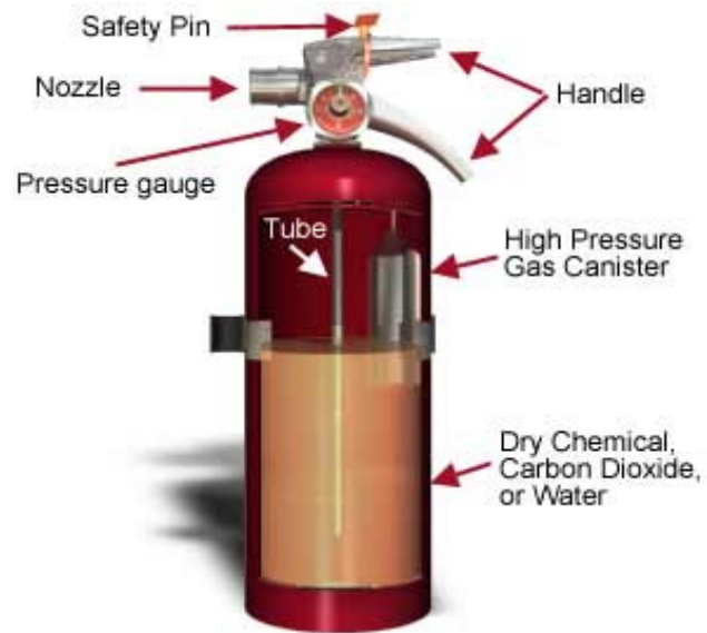
Gambar 10. Bagian-bagian Tabung APAR
